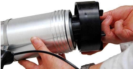
Réinstallez l'arrière en aluminium avec le régulateur de pression et l'écrou à chapeau noir sur le pistolet de réparation.
