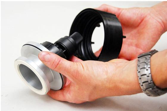
Retirez l'écrou à chapeau noir du régulateur de pression et de l'arrière en aluminium.
