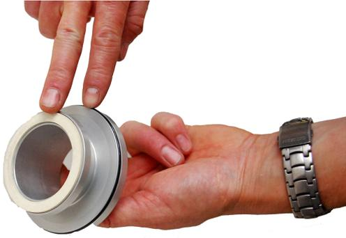
Vérifiez tant le joint en caoutchouc blanc que le joint torique. Ils doivent être propres et bien fixés.
