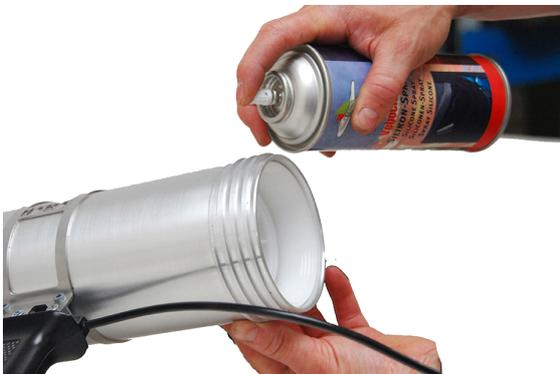
Appliquez du spray de silicone (108401BP032) sur le pas de vis du pistolet de réparation, là où l'écrou à chapeau noir est fixé.
