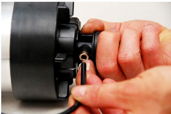
Débranchez le petit tuyau à air noir du régulateur de pression (108401AS103) à l'arrière du pistolet de réparation.
