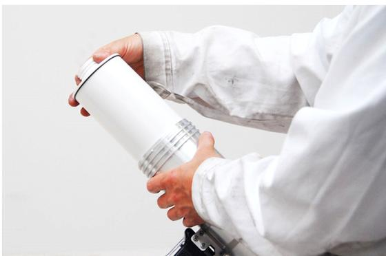
La cartouche de remplissage peut à présent être remplie manuellement ou avec la machine à projeter de HAMA. Insérez ensuite la cartouche de remplissage pleine dans le pistolet de réparation.
