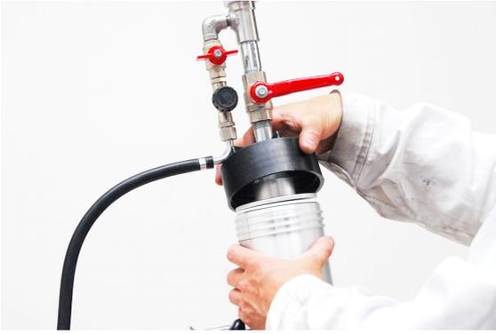
Refixez l'écrou à chapeau noir (108401PA003) avec la partie de projection sur le pistolet de réparation.
