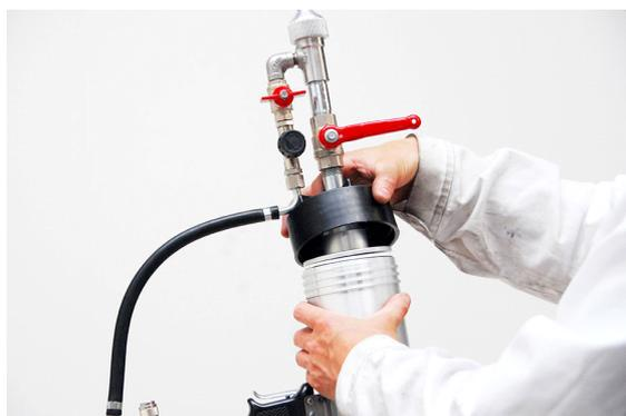
Dévissez l'écrou à chapeau noir avant (108401PA003) avec la partie de projection du pistolet de réparation et enlevez-les.
