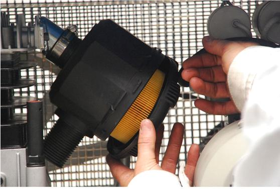
Remettez le filtre à air (2012666) en place et revissez le couvercle sur le logement du filtre à air.
