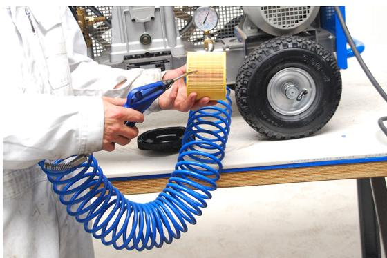
Raccordez un pistolet à air sur le tuyau à air ou éventuellement directement sur le compresseur et soufflez pour nettoyer le filtre à air.
