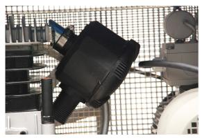
Entfernen Sie den Deckel vom Filterbehälter.
