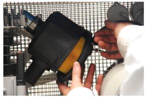
Bauen Sie den Luftfilter (2012666) wieder ein und drehen Sie den Deckel wieder auf das Luftfiltergehäuse.
