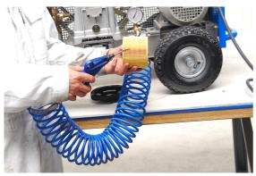
Schließen Sie eine Luftpistole an den Luftschlauch oder eventuell direkt an den Kompressor an und reinigen Sie den Luftfilter mit Druckluft.
