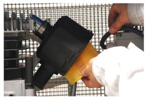
Nehmen Sie den Luftfilter (2012666) aus dem Luftfiltergehäuse.
