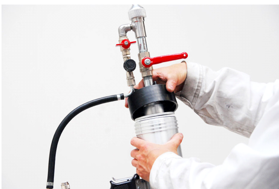
Lösen und entfernen Sie die vordere schwarze Überwurfmutter (108401PA003) inklusive Spritzteil von der Reparaturpistole.
