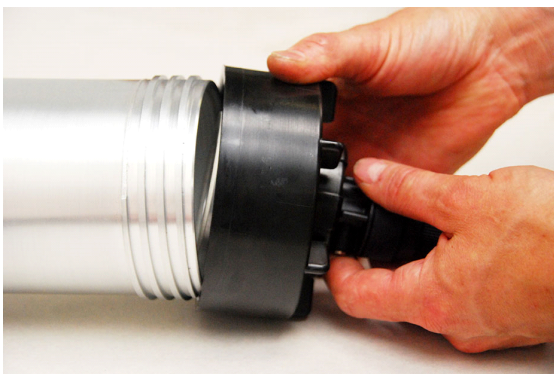
Lösen Sie die schwarze Überwurfmutter (108401PA003) an der Rückseite der Reparaturpistole.
