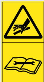
N'essayez JAMAIS de localiser une fuite avec vos doigts. Utilisez un morceau de carton à cet effet. L'air comprimé sous haute pression peut contenir de l'huile de compression qui peut traverser la peau. L'huile passée à travers la peau entraîne une situation d'urgence. Il y a un risque d'infection ! Rendez-vous immédiatement chez un médecin !
